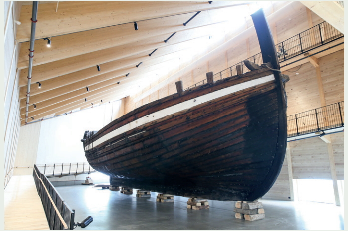
Middelaldereskuta Holvikjekta er 20 meter lang og ni meter bred. Den ble bygget i 1881 av lokale handverkere på Sandane og gikk med ved og trelast til Bergen frem til jektene ble utkonkurrert av motoriserte båter. I 1906 ble den satt på land. Nå har den fått sitt eget museumsbygg.
